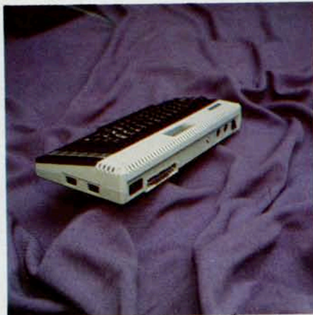
Utgångarna från vänster: joystick/paddle, diskett/bandstation, minnesexpansion, tv, monitor, transformator och längst till höger strömbrytare.
