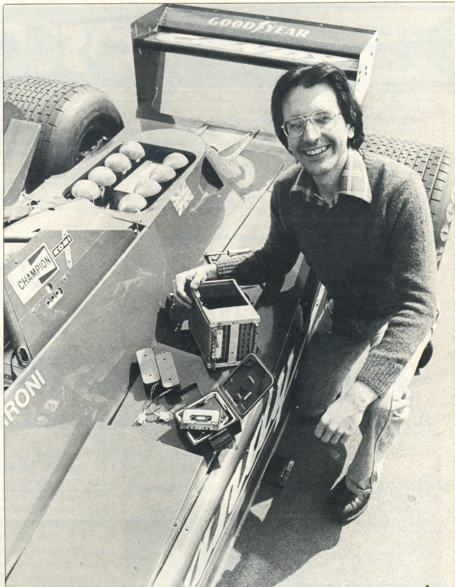
Karl Kempf med den mobila datorutrustning han utvecklat åt Tyrrell Racing i England. Minnesenheten är väl inkapslad i en isolerad låda, som förhindrar störningar p g a vibrationer eller det elektroniska tändsystemets impulser.
